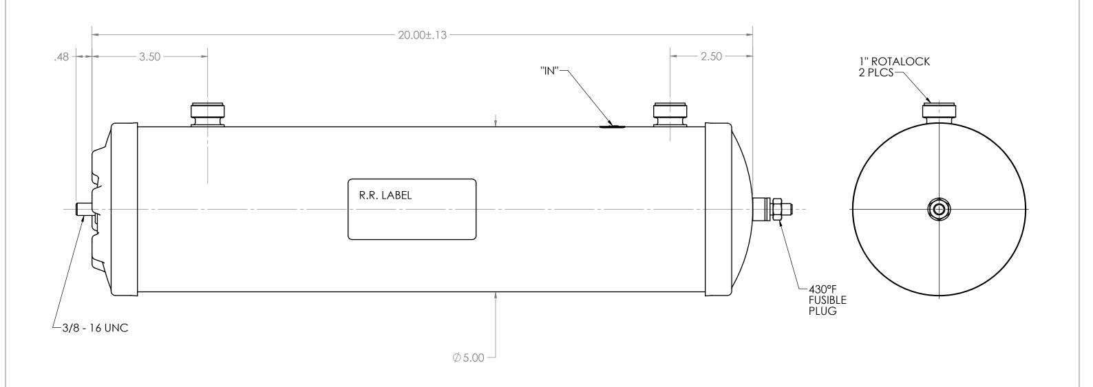
FOR HORIZONTAL OPERATION HAVE ROTALOCK FITT. UP FOR VERT. OPPERATION HAVE STUD DOWN
